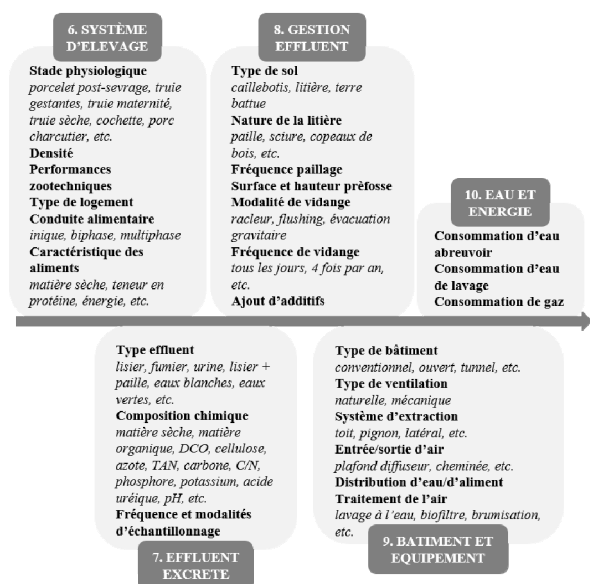
Figure 2 : Structure des blocs pour le poste bâtiment
