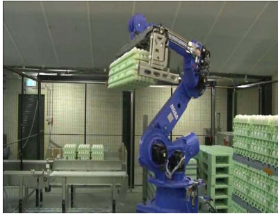
Photo 7. Robot palettiseur d'alvéoles d'œufs (ici MR 40 de MOBA)
