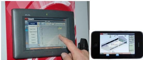
Photos 4 et 5. Boîtier tactile AVITOUCH (Tuffigo Rapidex) pour la centralisation des paramètres d'élevage et accès à distance au boîtier aux données par smartphone.
