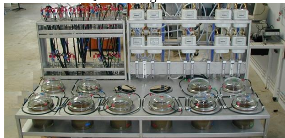
Figure 1 : Plateau expérimental de mesures des émissions de \text{NH}_3 au stockage
