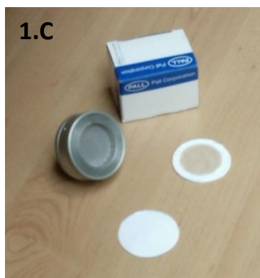
Figure 1 : Dispositifs de mesure des particules avec (1.A) compteur de particules optique GRIMM 1.109 ; (1.B) sa sonde de prélèvement isocinétique radiale ; (1.C) le porte-filtre et des filtres (avant/après mesure) et (1.D) Dispositif Porte-filtre et filtre pendant une mesure.
