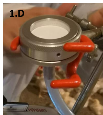
Figure 1 : Dispositifs de mesure des particules avec (1.A) compteur de particules optique GRIMM 1.109 ; (1.B) sa sonde de prélèvement isocinétique radiale ; (1.C) le porte-filtre et des filtres (avant/après mesure) et (1.D) Dispositif Porte-filtre et filtre pendant une mesure.
