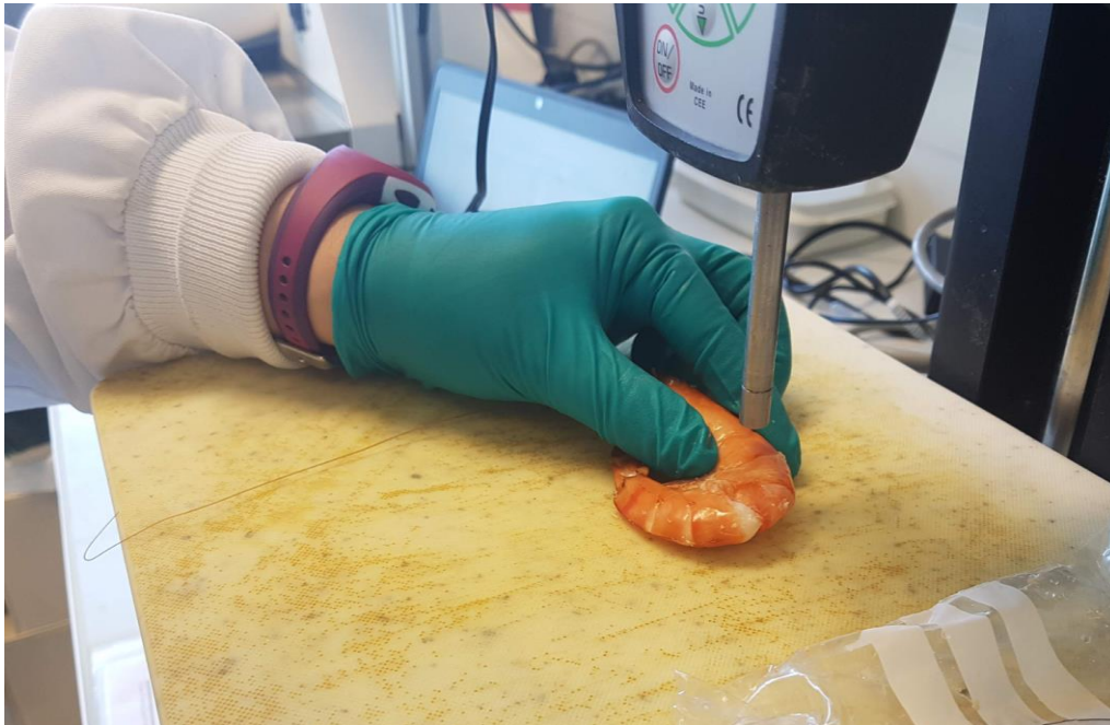
Mesure de la fermeté sur une crevette cuite
