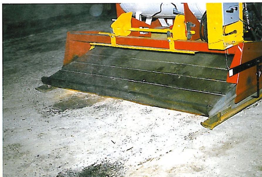
Nettoyeur thermique NTA en cours de traitement.
