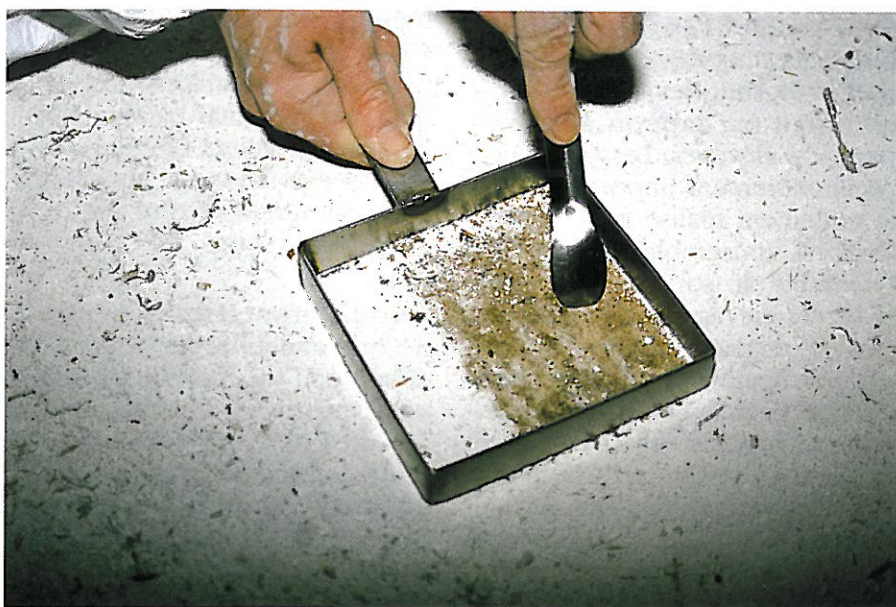
Réalisation d'un prélèvement de sol par grattage
