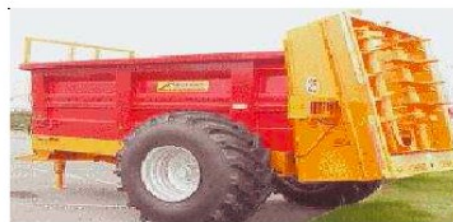
Epandeur à herissons verticaux
