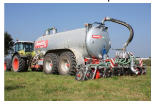
Exemple d'injecteur à disque pour un épandage sur prairies Source: Jeantil
