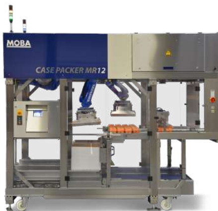
Robot encaisseur MR12 Capacité 32 400 œufs/heure
