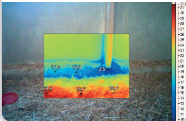
■ Figure 5 — Bâtiment label en chauffe avant le démarrage. Le soubassement en béton est une zone non isolante et directement à hauteur de vie des poussins. Il peut constituer un risque de refroidissement des poussins à son contact ou son environnement. L'augmentation de la quantité de paille contre le sous-bassement peut-être alors conseillée..
