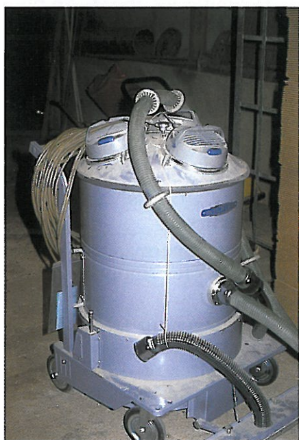
L'utilisation d'un aspirateur industriel optimise le dépoussiérage
