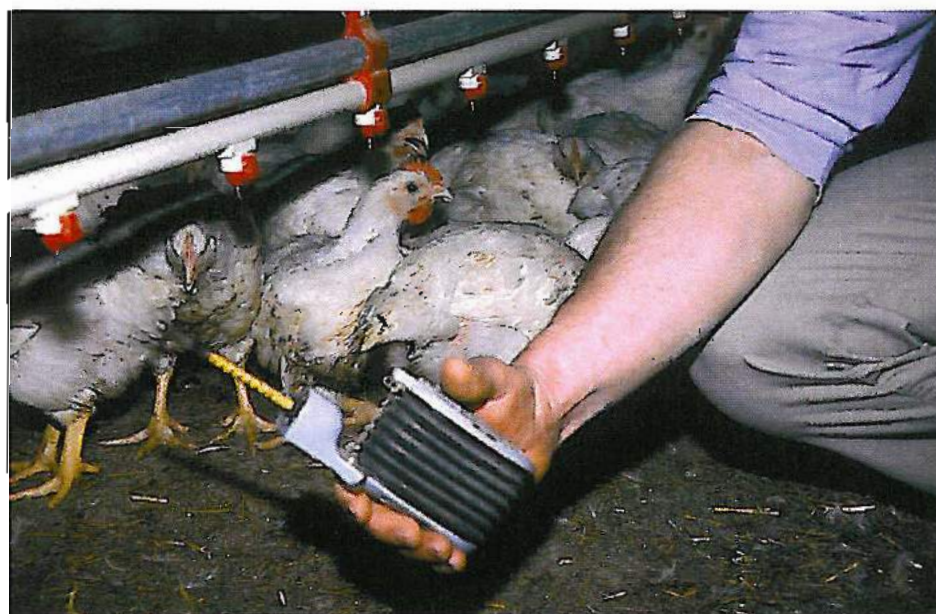
Contrôle du taux d'ammoniac à l'aide d'une pompe Draeger dans la zone de vie des animaux.
