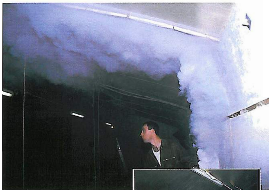
Il est nécessaire de bien localiser les circuits d'air dans le bâtiment en réalisant des fumigènes ou en fixant des repères (bandes magnétiques, papier...)
