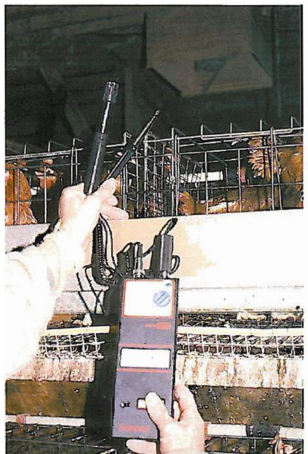
Contrôle des principaux paramètres d'ambiance (température, hygrométrie, vitesse d'air) en bâtiment de poules pondeuses.
