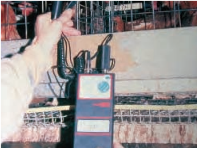
L'anémomètre, un instrument très utile pour mesurer les vitesses d'air
