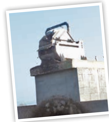
Le tamis vibrant : une solution de séparation de phase.
