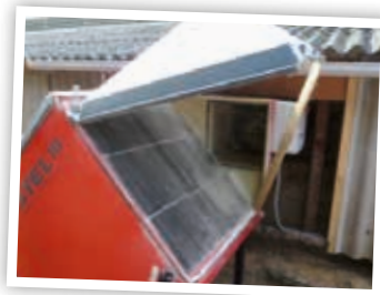
Échangeur de chaleur type PRC 180 (Systel).
