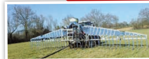
L'épandeur à cordon ombilical évite les éclaboussures et donc limite les odeurs
