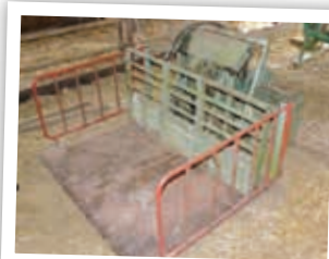
Le module de Bernard pousse les caisses pour les décharger facilement.
