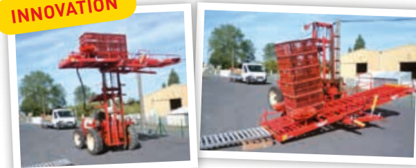
Plusieurs positions pré-enregistrées permettent le chargement et déchargement des caisses.
