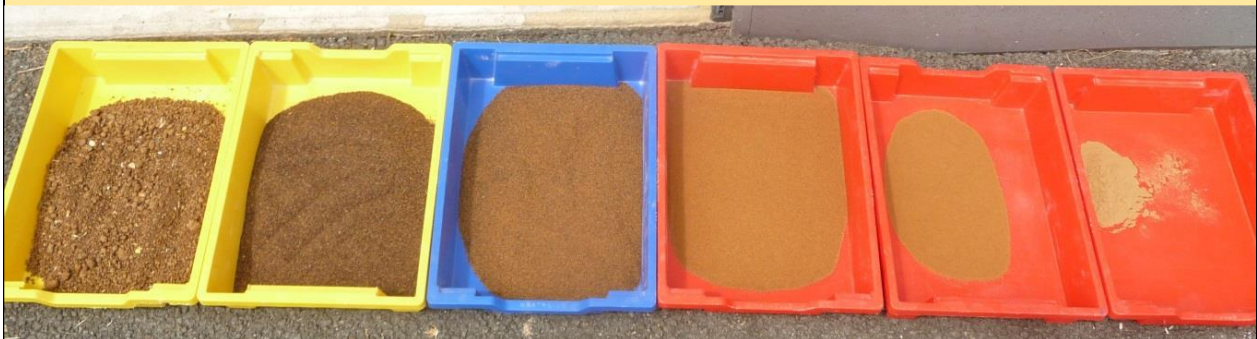
Figure 2. Fractions obtenues par tamisage du tourteau de colza : de gauche à droite : 1) > 1000 \mu\text{m} , 2) entre 500 et 1000 \mu\text{m} , 3) entre 250 et 500 \mu\text{m} , 4) entre 150 et 250 \mu\text{m} , 5) entre 100 et 150 \mu\text{m} , 6) < 100 \mu\text{m}
