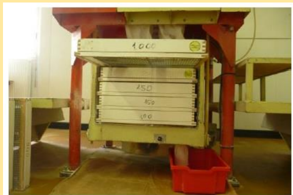
Figure 3. Plansichter avec tamis de 1000 \mu\text{m} , 500 \mu\text{m} , 250 \mu\text{m} , 150 \mu\text{m} et 100 \mu\text{m} (ENSMIC)
