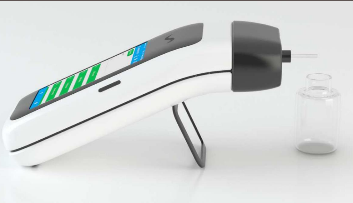
Le nez électronique NeOse (Source : Aryballe Technologies)
