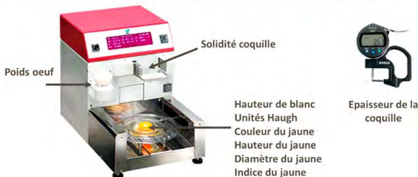
Digital Egg Tester utilisé pour l'analyse de la qualité macroscopique des œufs - © ANR EQLIPSE
