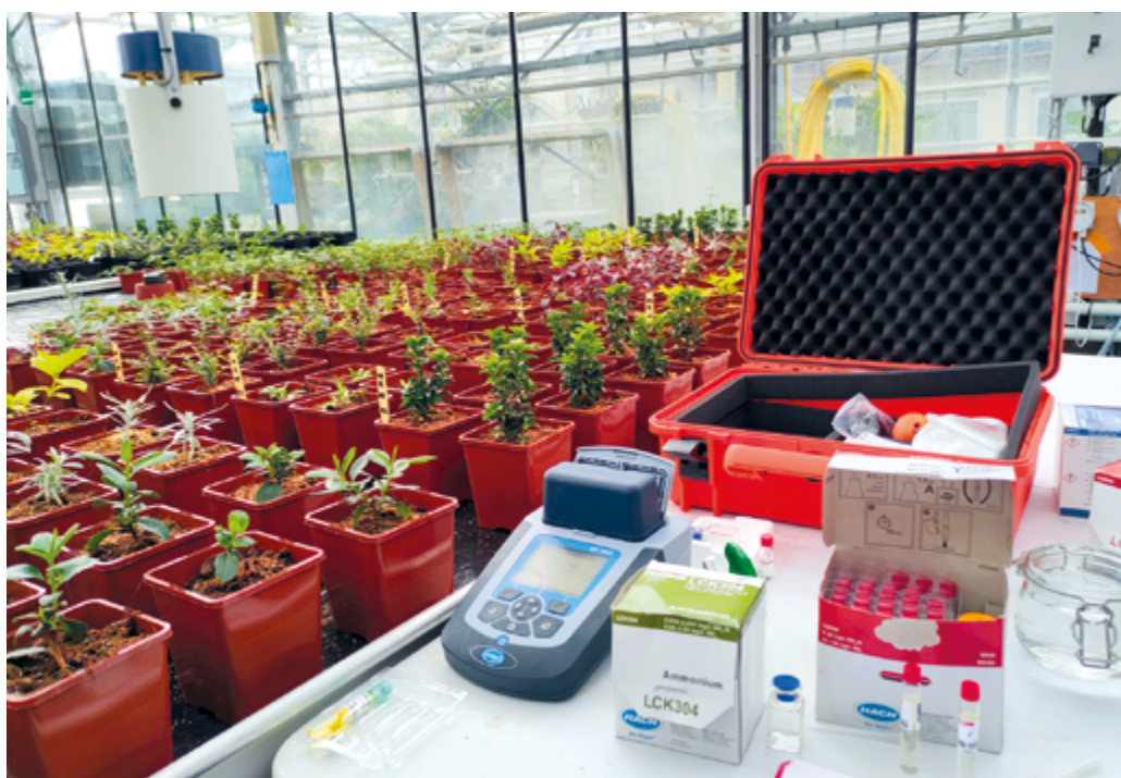
Suivis qualité d'eau du système aquaponique de Fauville-en-Caux par spectrophotométrie.
