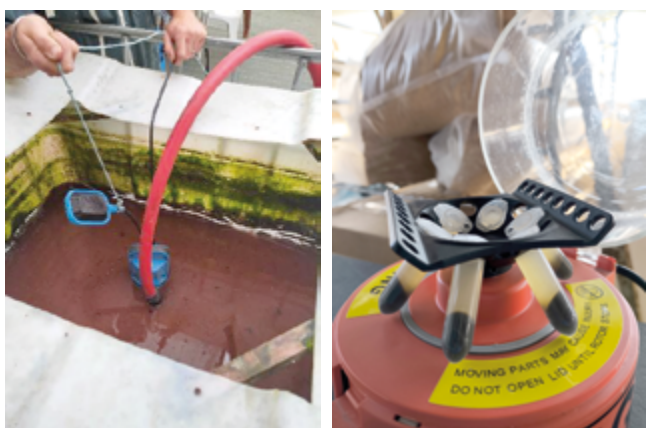
Soutirage et centrifugation pour analyse des boues piscicoles de la Ferme Aquaponique de l'Abbaye (76).
