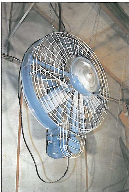
Disque à humidifier BÉCOT. (Un principe intéressant par les deux fonctions de brassage et d'humidification.)
